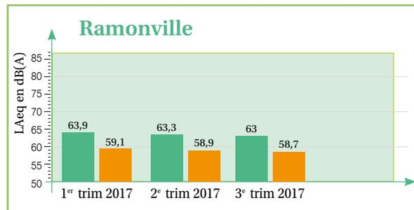
Le LAeq représente le niveau sonore continu et stable sur la durée de passage de l'avion, qui équivaut à la même énergie de pression sonore du bruit variable mesuré au passage de l'avion.
