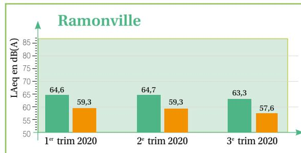
Le LAeq représente le niveau sonore continu et stable sur la durée de passage de l'avion, qui équivaut à la même énergie de pression sonore du bruit variable mesuré au passage de l'avion.
