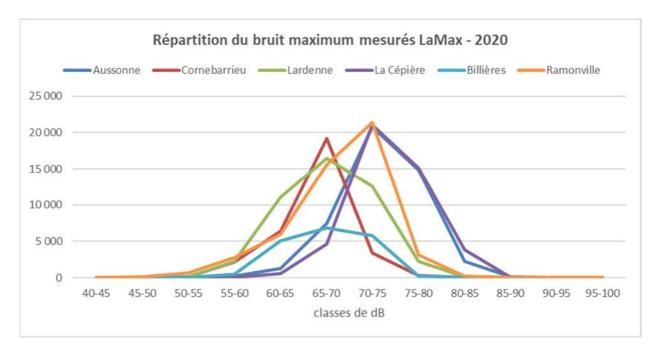
Le LaMax représente le bruit maximum atteint lors du passage d'un avion au-dessus d'un capteur.
