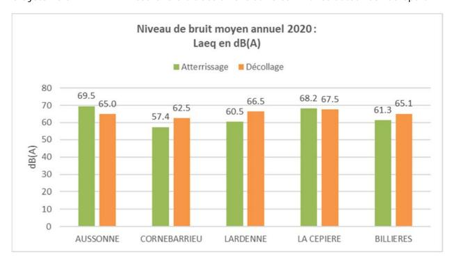
Le Laeq est une unité de bruit décrivant le bruit moyen calculé sur la durée de passage de l'avion.
