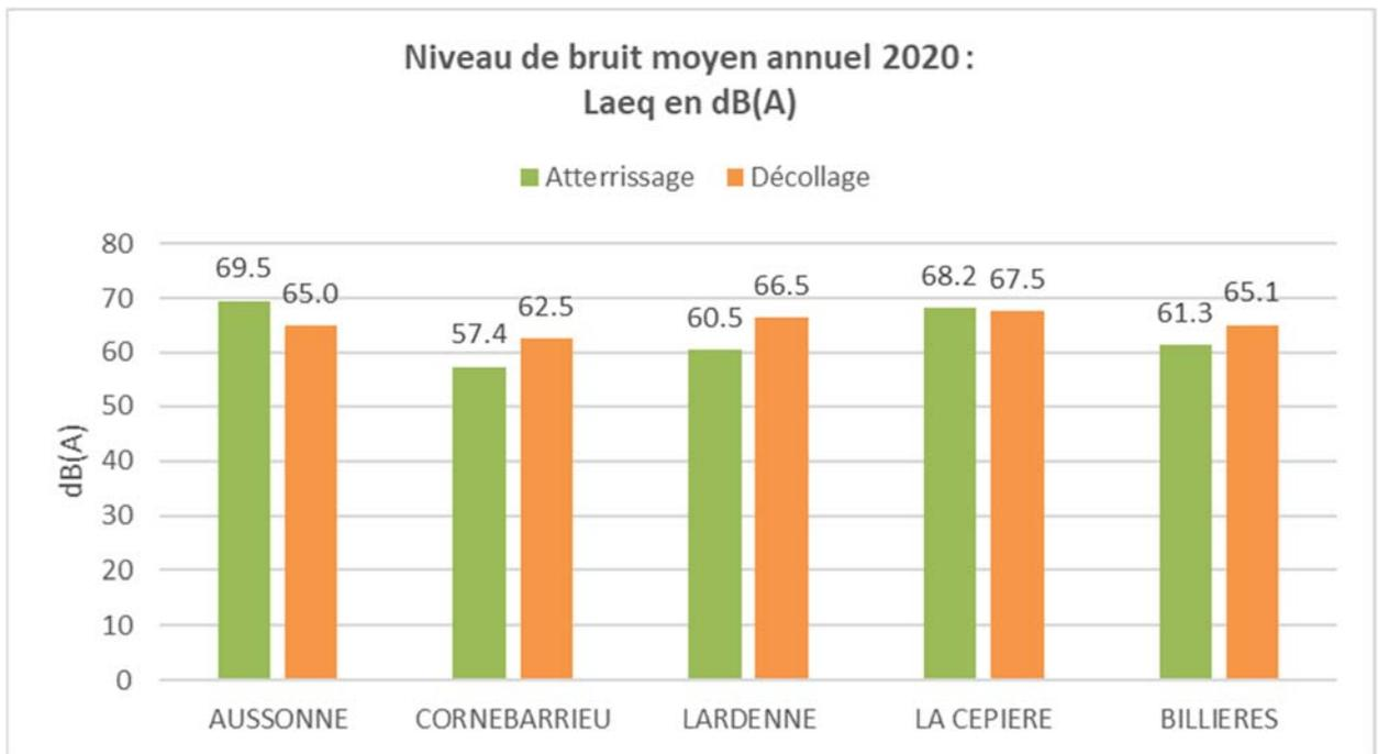
Le Laeq est une unité de bruit décrivant le bruit moyen calculé sur la durée de passage de l'avion.
