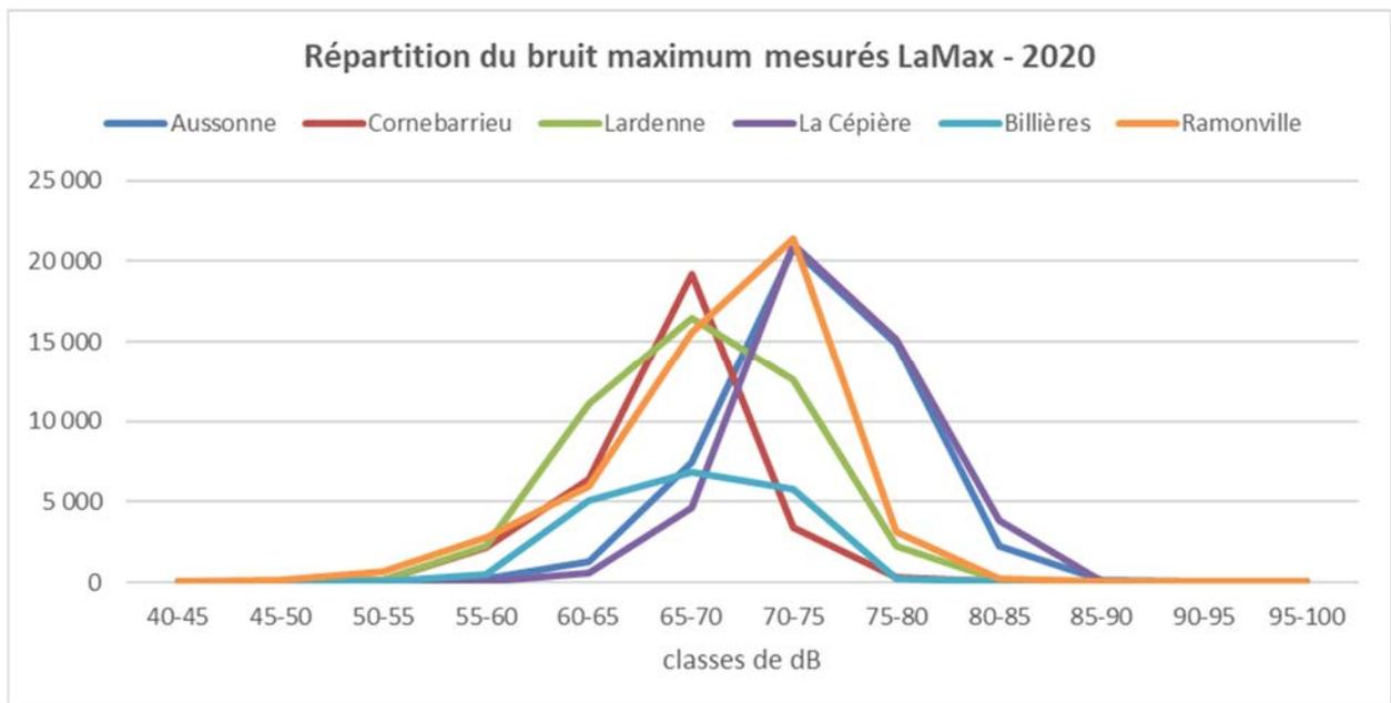
Le LaMax représente le bruit maximum atteint lors du passage d'un avion au-dessus d'un capteur.
