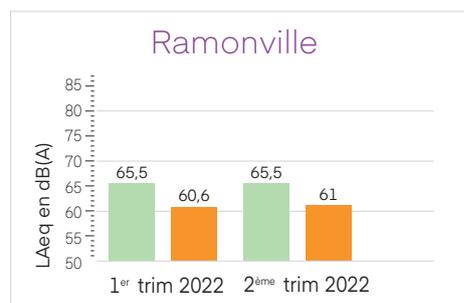
Le LAeq représente le niveau sonore continu et stable sur la durée de passage de l'avion, qui équivaut à la même énergie de pression sonore du bruit variable mesuré au passage de l'avion.
