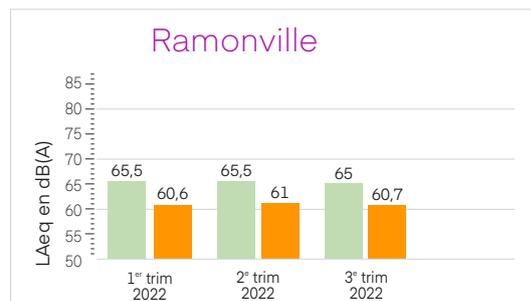
Le LAeq représente le niveau sonore continu et stable sur la durée de passage de l'avion, qui équivaut à la même énergie de pression sonore du bruit variable mesuré au passage de l'avion.
